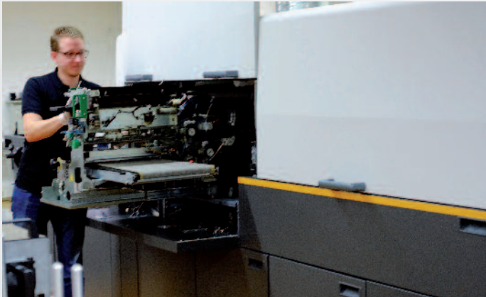
Die meisten Wartungsarbeiten können an der Nexpress vom Bediener selbst durchgeführt werden.
